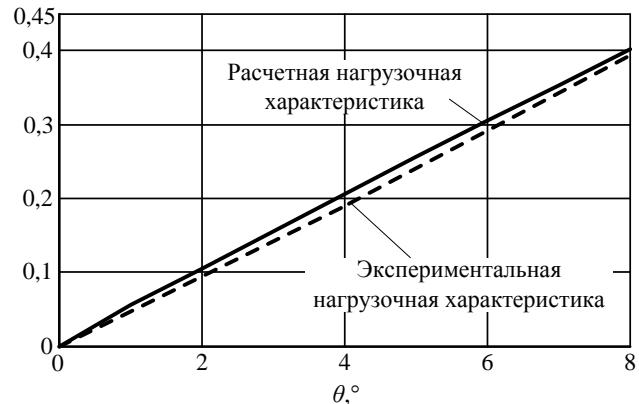
Рис. 6 – Расчетная и экспериментальная нагрузочные характеристики масштабной модели механизма наклона
