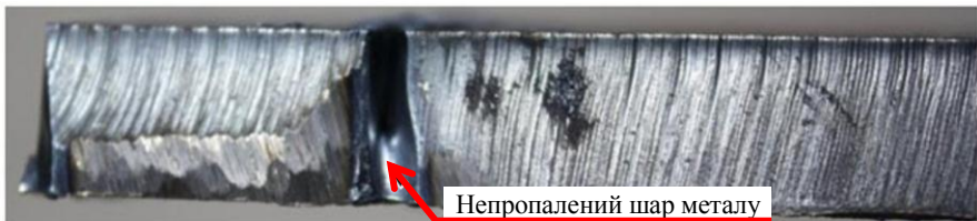
Рис. 5 – Непропалений метал при товщині листа 12 мм
