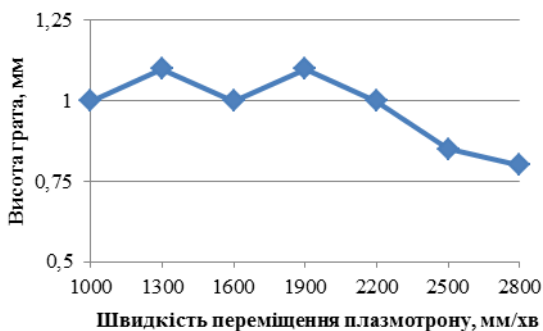
Рис. 3 – Залежність висоти ґрата від швидкості переміщення плазмоторону при силі струму I=40 А
