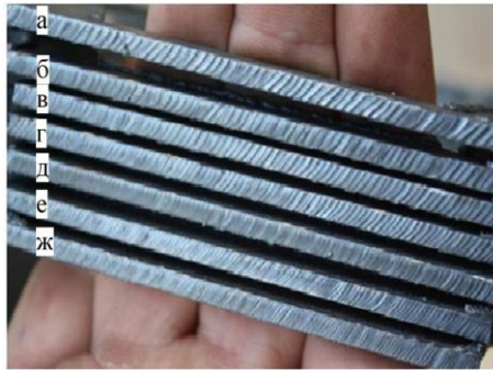
Рис. 1 – Хвилястість на поверхні розрізаного металу товщиною 3 мм при силі струму 40 А: а – S = 1000 мм/хв, p = 1,3 мм; б – S = 1300 мм/хв, p = 1,1 мм; в – S = 1600 мм/хв, p = 1,0 мм; г – S = 1900 мм/хв, p = 0,8 мм; д – S = 2200 мм/хв, p = 0,75 мм; е – S = 2500 мм/хв, p = 0,7 мм; ж – S = 2800 мм/хв, p = 0,4 мм
