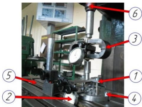
Рис. 6 – Установка для вимірювання сил та переміщень у вертикальній площині
