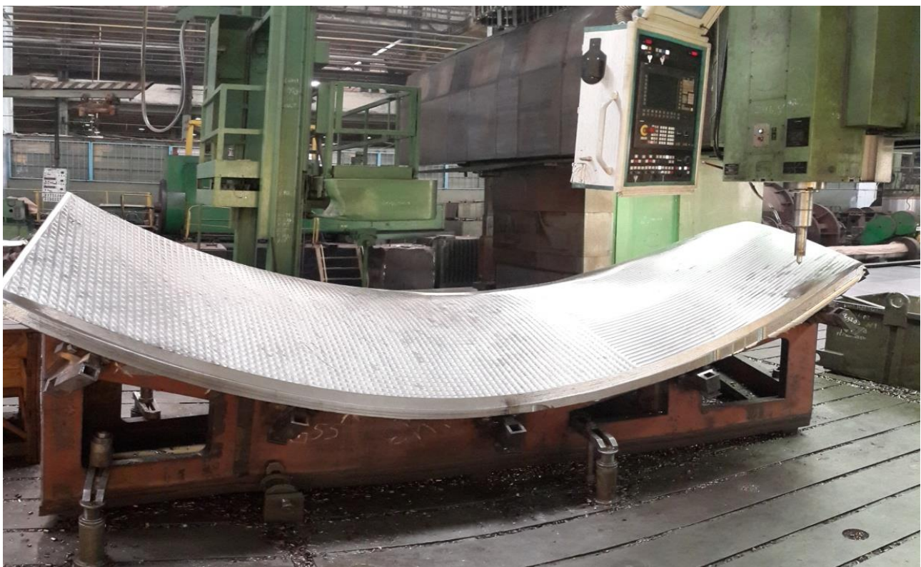
Рис. 10 – Фрезерование лопасти на станке с ЧПУ фирмы Waldrich Coburg (Германия)
