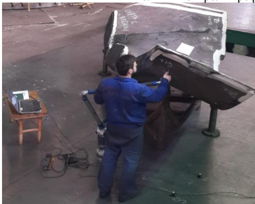
Рис.12 – Контрольная разметка лопасти под механическую обработку
