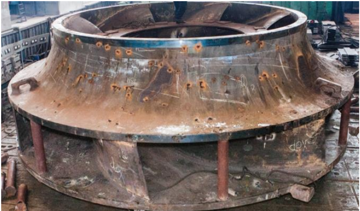
Рис. 6 – Рабочее колесо Днестровской ГАЭС после сварки
