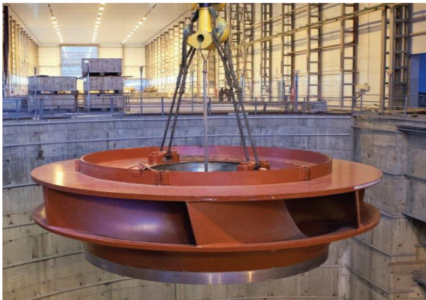
Рис.2 – Рабочее колесо Днестровской ГАЭС
