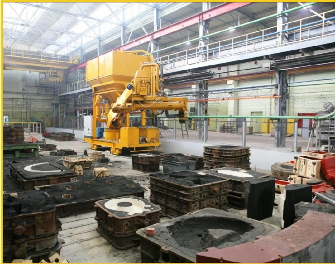
Рис.3 – Новый мобильный смеситель ф. IMF (Италия)
