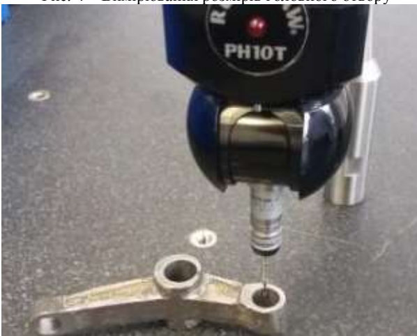
Рис. 5 – Вимірювання розмірів допоміжного отвору, що паралельний головному
