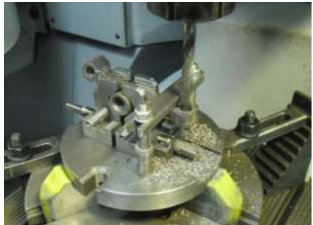
Рис. 2 – Обробка допоміжного отвору важеля, що перпендикулярний головному, у запропонованому верстатному пристрої
