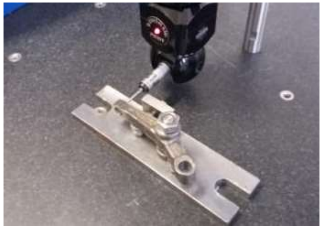
Рис. 6 – Вимірювання розмірів допоміжного отвору, що перпендикулярний головному
