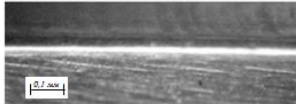
Рис. 3 – Зовнішній вигляд РК шпонкових фрез після MAO
