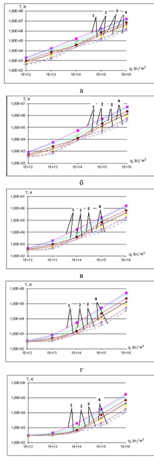
Рис. 1 – Зависимости максимальной температуры –  $T$  от плотности теплового потока  $q$  создаваемого лазерным излучением при разных временах его действия (а- $10^{-10}$ , б- $10^{-11}$ , в- $10^{-12}$ , г- $10^{-13}$ , д- $10^{-14}$ , е- $10^{-15}$ , ж- $10^{-16}$  с) и на разной глубине (1- $x=0$ , 2- $x=1$ , 3- $x=2$ , 4- $x=3$ ) при разных способах задания теплофизических и термомеханических характеристик: — квантово-механическим методом, - - - стохастическим методом
