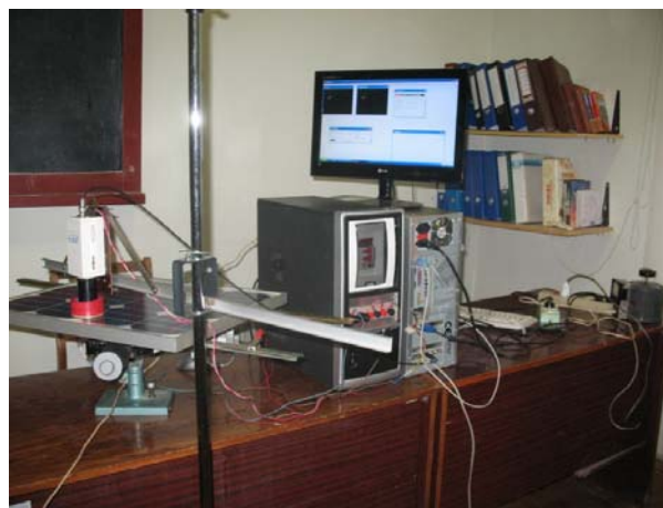
Рис. 4 – Зовнішній вигляд стенду телевізійного контролю
