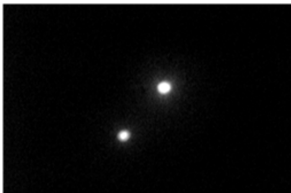
Рис. 5 – Електролюмінесцентні дефекти сонячного елемента на кристалічному кремнії, збільшення у 50 раз, відстань між дефектами 200 мкм
