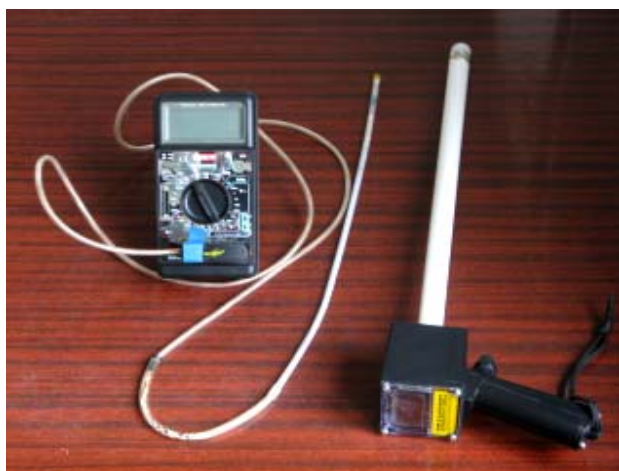
Рис. 2 – Система для измерения изменений температуры (слева) и прибор “Draminski estrous detector” для измерения электрического сопротивления (справа)
