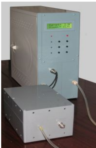
Рис. 1 – Установка для синтеза низкоконцентрированных растворов гипохлорита натрия, оборудованная микроконтроллерной системой управления и контроля технологических параметров
