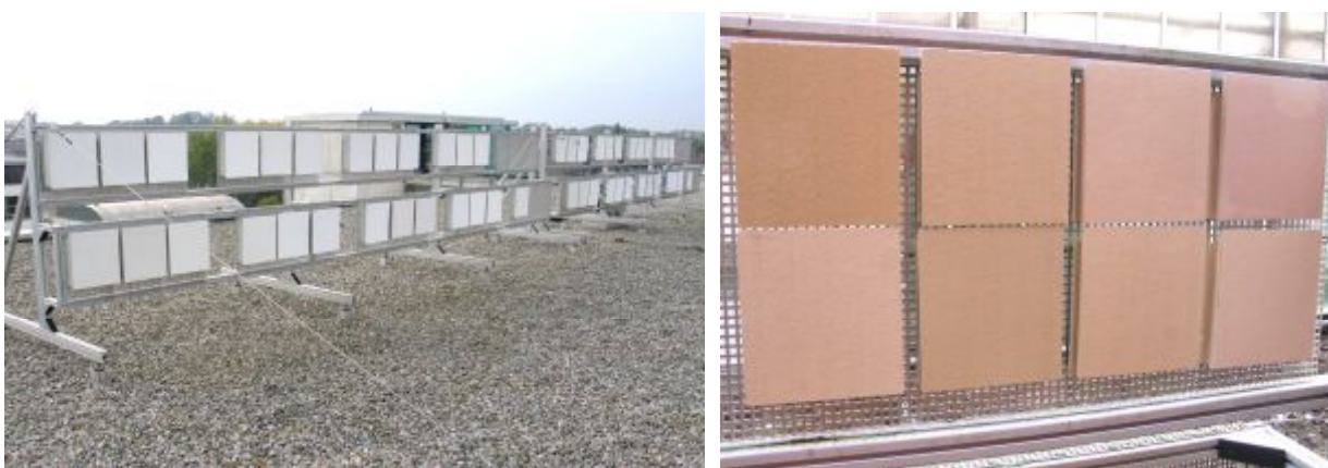
Рис. 2. – Проверка биоустойчивости образцов материалов на полевом стенде
