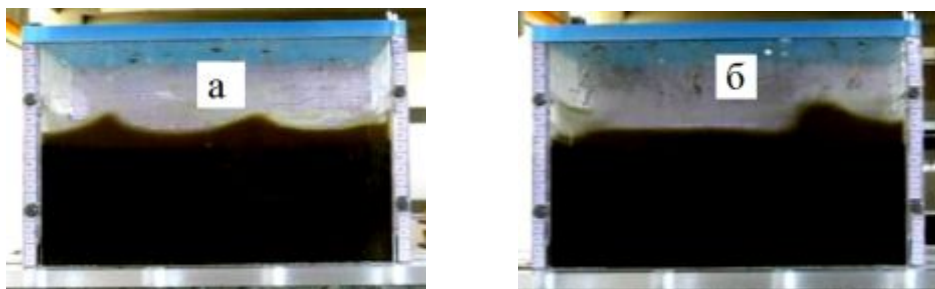
Рис. 8. – Песок с содержанием влаги 40 % под воздействием высоких частот и малой амплитуды: а – f = 2,5 Гц, a = 2,37 см; б – f = 1,4 Гц, a = 4,3 см.
