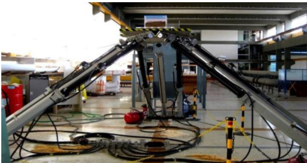
Рис. 4 – Вибрационный стол школы военно-морской архитектуры и морских работ
