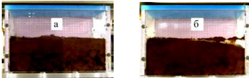
Рис.6 – Влажный жмых до применения колебаний (а) и после (б) ( f = 2,2\text{Гц} , A = 4,3\text{см} ).
