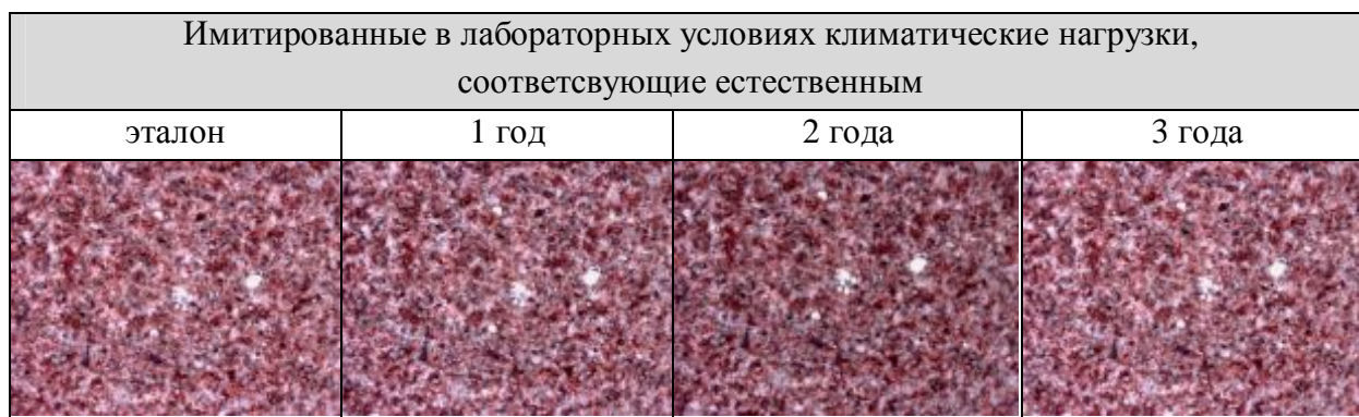
Рис. 6 – Фрагмент поверхности пробы красного песчаника с анти-граффити-покрытием А фирмы SCHEIDEL
