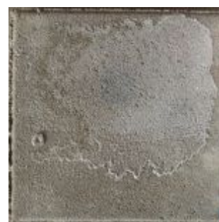
Рис. 3 – Результаты трехступенчатой химической очистки поверхности бетона
