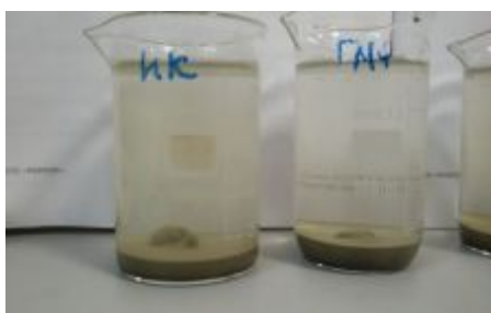
Рис. 5 – Формирование купола в системах с добавками НК и ГМФН
