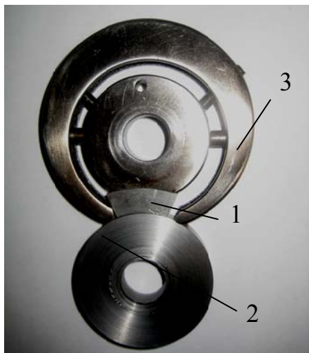
Рис. 1. Взаємне розташування зразків під час випробувань: 1 – колодка; 2 – диск (контртіло); 3 – оправка
