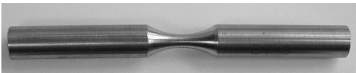
Рис. 1. Образец для испытаний на усталость
