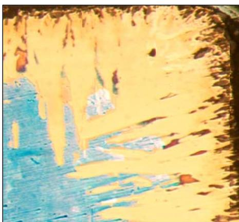
Рис. 4. Микроструктура поверхностного слоя стали У7 после борирования, подвергнутая тепловому травлению, ×100
