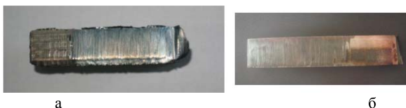
Рис. 2. Оброблена поверхня заготовки із сталі 45 з бронзовими стрижнями (а) та послідовні стадії знімання поверхневих шарів після обробки (б)
