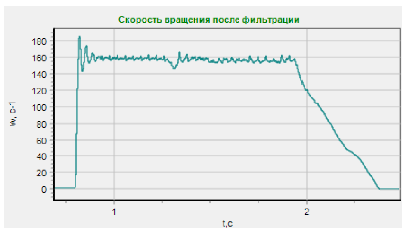
Рис. 11. График переходного процесса скорости асинхронного двигателя при пуске, набросе нагрузки и торможении на самовыбеге
