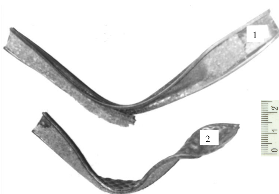
Рис. 4. Уплотнение сердечника порошковой ленты после прокатки с различным усилием и термической обработки:
