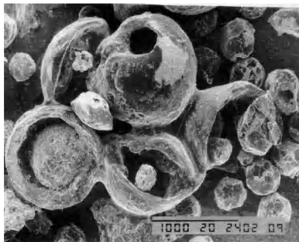
Рисунок 4 – Вид под микроскопом брызг чугуна.
