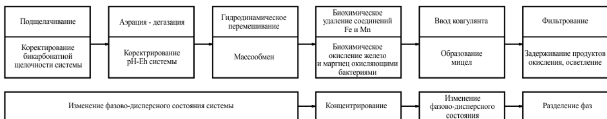
Рисунок 6 – Блок-схема кондиционирования многокомпонентных подземных вод с изменениями фазово-дисперсного состояния рассматриваемых систем внутри технологического процесса.
