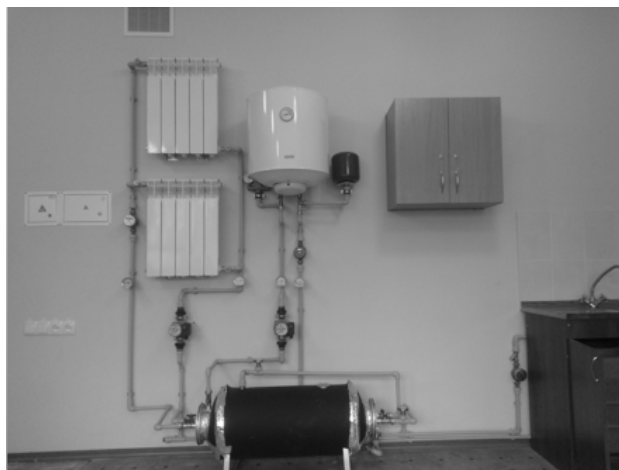
Рисунок 3 – Лабораторная установка для исследования теплотехнических характеристик теплообменников различной конструкции.
