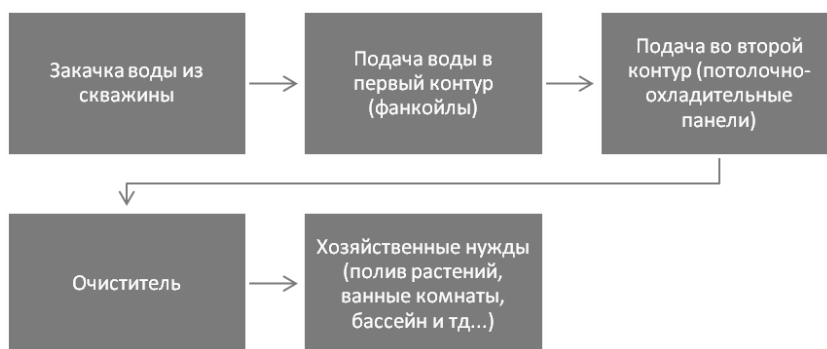
Рисунок 2 – Схема использования артезианской воды в качестве естественных источников холода для системы кондиционирования воздуха.
