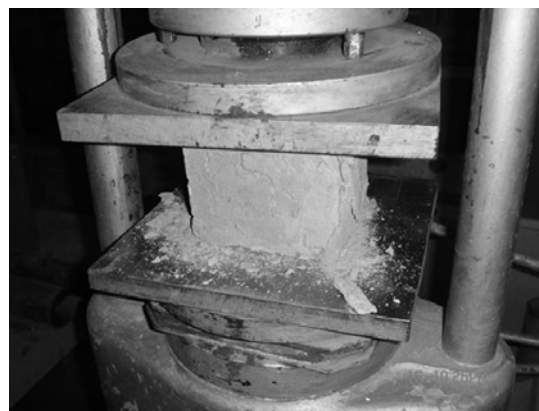
Рисунок 2 – Характер разрушения образца грунтобетона со стальной фиброй.
