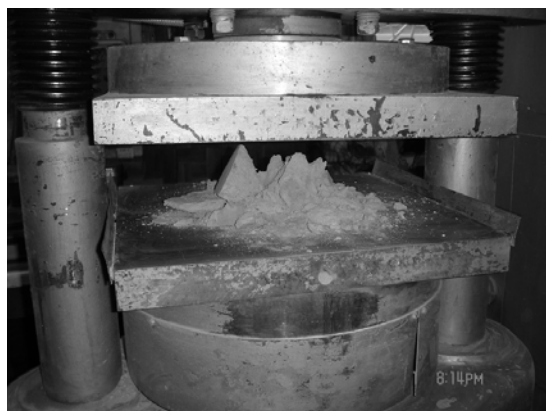
Рисунок 1 – Характер разрушения неармированного образца грунтобетона.
