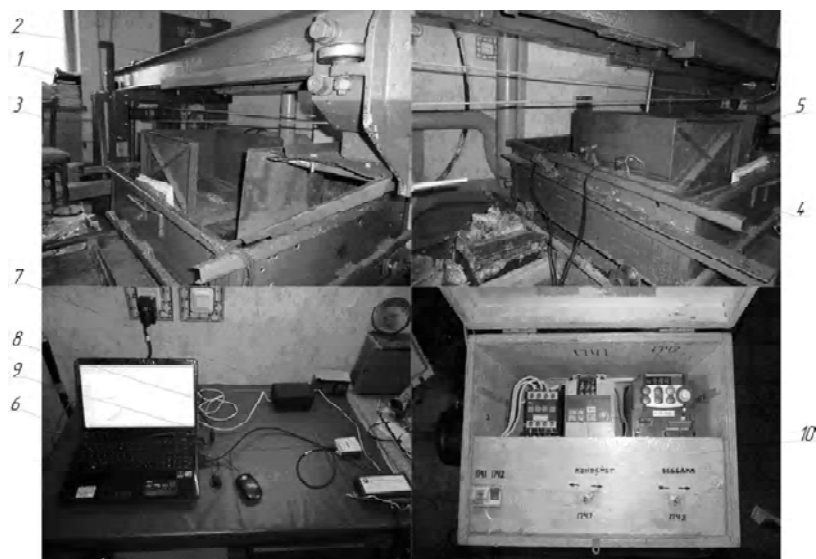
Рисунок 1 – Общий вид станда прессования ТБО: 1 – привод; 2 – рама станда; 3 – ящик имитирующий кузов мусоровоза; 4 – датчик измерения усилия прессования; 5 – прессующая плита; 6 – ЭВМ; 7 – блок питания усилителя; 8 – контроллер national instruments для преобразования сигнала; 9 – четырехканальный усилитель; 10 – блок частотного регулирования привода.
