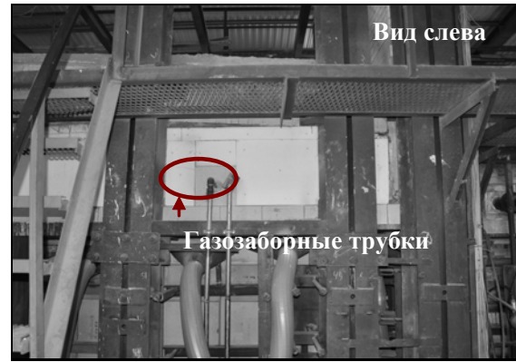
Рисунок 9 – Расположение газозаборных трубок в печи (вид слева).
