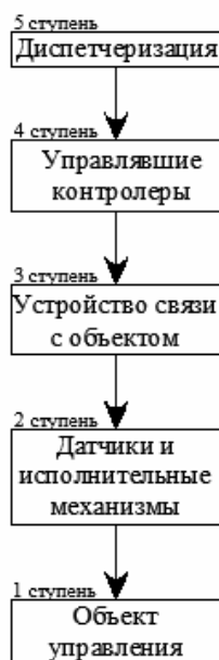
Рисунок 1 – Иерархическая схема АСУ систем централизованного теплоснабжения здания [3, 4].
