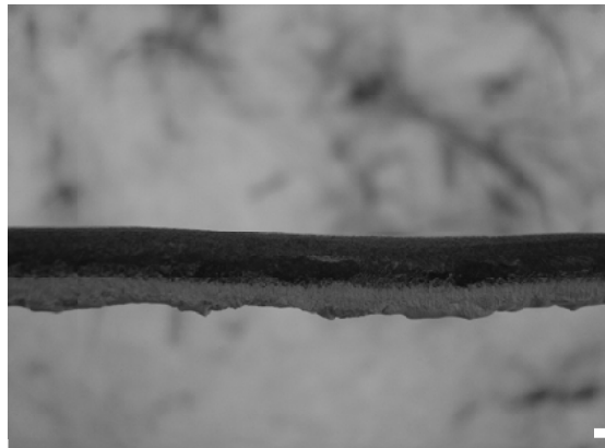
Рисунок 1 – Характер отложения пыли на лобовой стороне прута.
