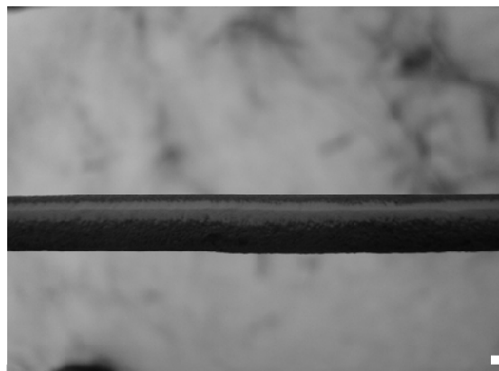
Рисунок 2 – Характер отложения пыли на тыльной стороне прута.
