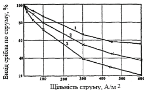
Рисунок 2 – Залежність виходу іонів срібла по струму від анодної щільності струму при різному вмісті срібла в аноді: 1 – проба 999,9; 2 – проба 875; 3 – проба 800.
