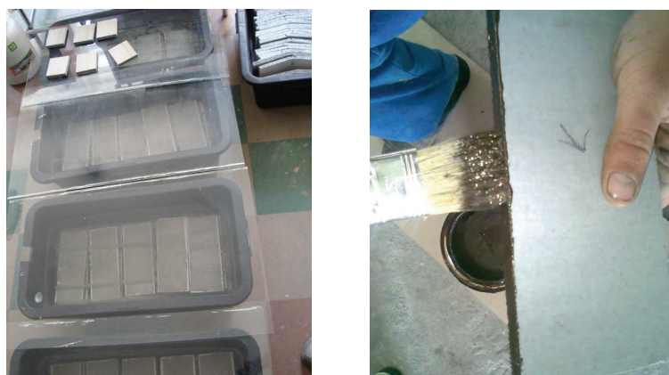
Рисунок 2 – Подготовка образцов и процесс оттаивания при испытаниях на морозостойкость.
