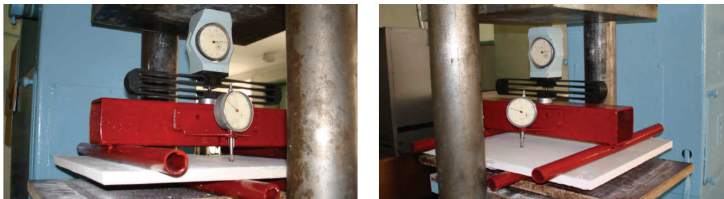
Фото 3 – Приспособление для испытания стыков гипсокартонных образцов.
