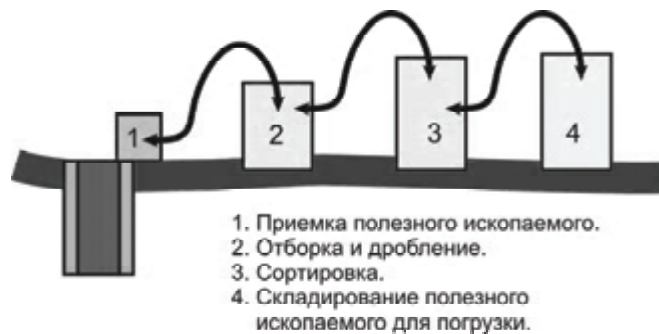
Рисунок 3 – Схема смешанной компоновки технологического комплекса на поверхности шахты [1].
