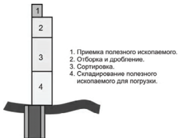
Рисунок 1 – Схема вертикальной компоновки технологического комплекса на поверхности шахты [1].
