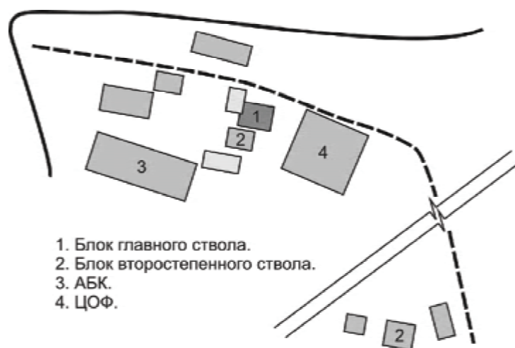
Рисунок 6 – Схема расположения объектов на нескольких промышленных площадках.
