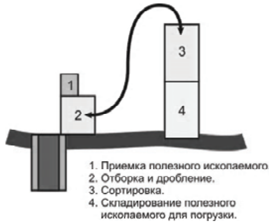
Рисунок 2 – Схема горизонтальной компоновки технологического комплекса на поверхности шахты [1].
