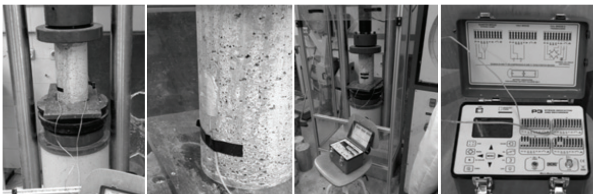
Рисунок 6 – Экспериментальное определение модуля упругости самоуплотняющегося бетона.
