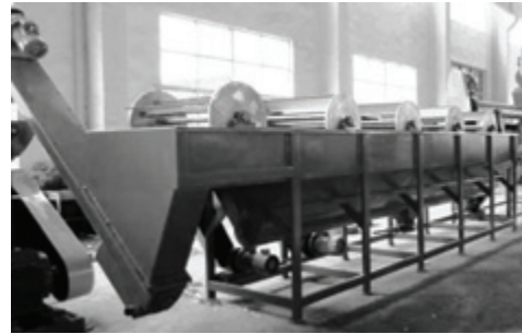
Рисунок 3 – Схема действия и внешний вид установки для повышения качества золы-уноса ТЭС методом флотации: 1 – пирамидальные емкости; 2 – ленточный вакуум-фильтр; 3 – сушилка; 4 – выходные отверстия с вентилями; 5 – отработанная суспензия; 6 – порог для ограничения уровня суспензии; 7 – скреб для съема всплывших микросфер.
