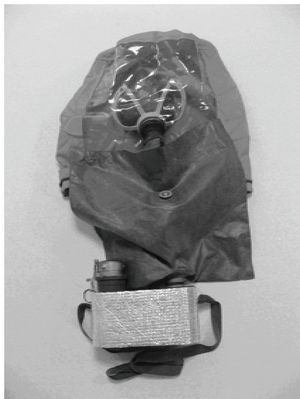
Рисунок – Самоспасатель СГЭ в рабочем состоянии.
