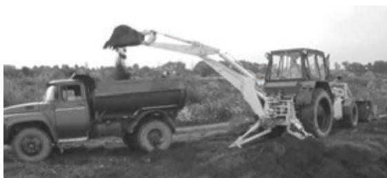
Рисунок 1 – Работа экскаватора в комплекте с самосвалом: а) фотография комплекта машин; б) технологическая схема копания.
