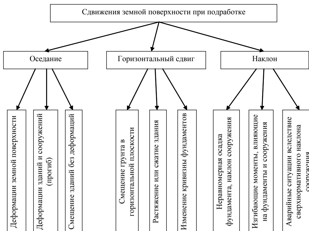
Рисунок 1 – Схема воздействия подработки на земную поверхность, здания и сооружения.
