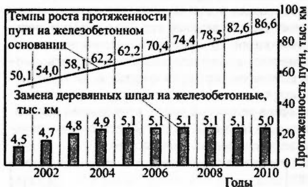
Рис. 1. Расширение полигона пути на железобетонных шпалах на железных дорогах Российской Федерации
