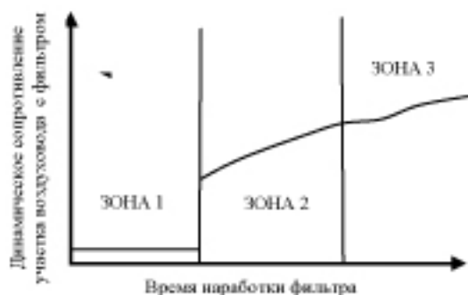
Рис. 2. Изменение выходного сигнала микроманометра А в процессе эксплуатации: ЗОНА 1 – установлен фильтр с поврежденным фильтрующим элементом, либо отсутствует (сигнал «Блокировка – авария фильтра»); ЗОНА 2 – штатная работа фильтра (сигнал – «Норма»); ЗОНА 3 – фильтрующий элемент подлежит замене (сигнал «Блокировка – заменить фильтр»)
