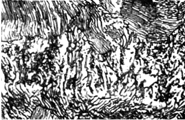
Рис.2. Структура стали после охлаждения 0.1 м/с длительностью 8 с, увеличение 2000
