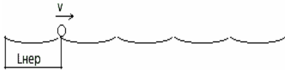
Рис. 3. Модель колії у вигляді безперервної нерівності
