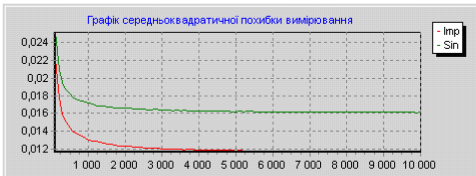
Рис. 6. Залежність шумової похибки вимірювання АЧХ від відношення сигнал/шум
