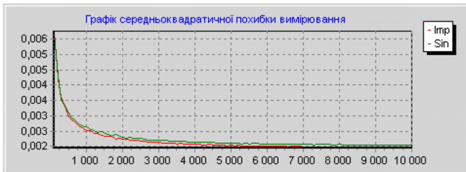
Рис. 5. Залежність похибки вимірювання перехідної характеристики від відношення сигнал/шум
