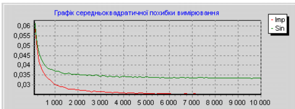
Рис. 7. Залежність шумової похибки вимірювання ФЧХ від відношення сигнал/шум
