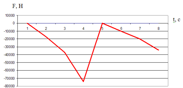
Рис. 6. Кривая, учитывающая и упрочняющий процесс, и приложенную эксплуатационную нагрузку для боковой рамы
