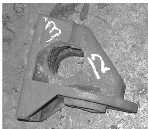
Рис. 6. Клин плоского действия с увеличенной высотой вертикальной поверхности в тележке 18-100М
