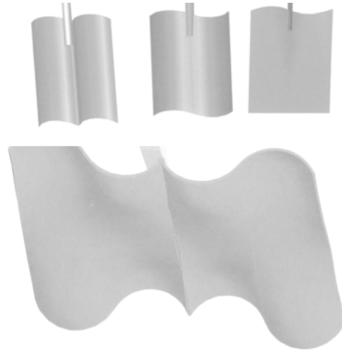
Рис. 7. Варианты лопастей переменного профиля
