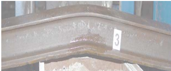
Рис. 7. Деформований зразок рейки № 3
