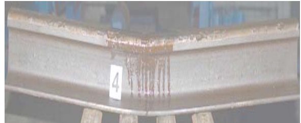
Рис. 8. Деформований зразок рейки № 4
