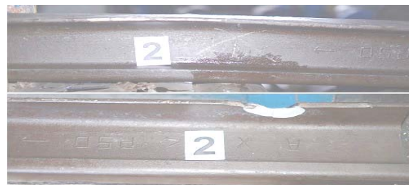
Рис. 6. Деформований зразок рейки № 2
