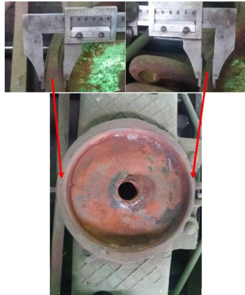
Рис. 1. Знос бурта підп'ятника вантажного вагона
