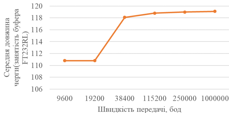
Рис. 5. Залежність середньої довжини черги від швидкості передачі за 1/10 обертання всіх валів при частоті обертання 1\,500\text{ хв}^{-1} , при часі опитування FT232RL 0,4 с.
