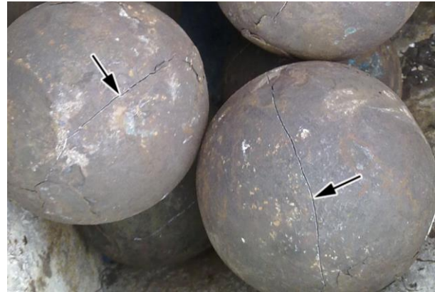
Рис. 1. Трещины на поверхности шаров, обработанных по режиму № 1
